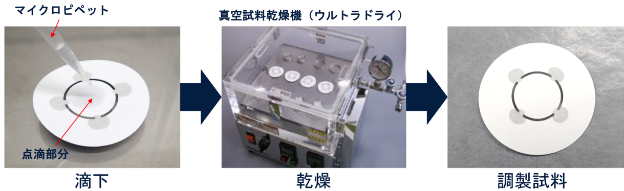
図2. 点滴法の試料調製手順.
